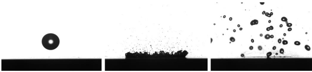
Abbildung 2: Einzeltropfenaufprall auf heiße Oberfläche - Entstehung von Sekundärtropfen
