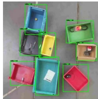
Roboterarm am IFL der autonom Objekte aus Boxen greift (links) und Objekterkennung für KLT (rechts)
