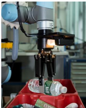
Roboterarm am IFL der autonom Objekte aus Boxen greift (links) und Objekterkennung für KLT (rechts)
